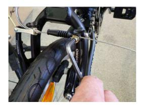
Ziehen Sie nun die Inbusschrauben an den Bremsen nach. Stellen Sie die Bremsen ein (siehe Bedienungsanleitung "Einstellen der Bremsen")
