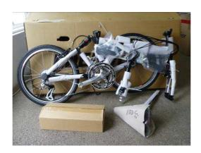
Packen Sie den Karton aus und entfernen Sie alle Verpackungsmaterialien. Die Sattelstütze und der Sattel sind separat. In dem kleinen Karton sind die Pedale, der Seitenständer, die Vorderradachse und eine Kunststoffkappe. Der Lenker ist mit Kabelbindern am Fahrrad befestigt. Zum Durchtrennen der Kabelbinder benutzen Sie am besten einen Seitenschneider.
