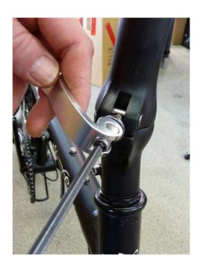
Entfernen Sie den Bolzen am Scharnier der Lenksäule und setzen Sie die Lenksäule auf das untere kurze Lenkerrohr. Nun schieben Sie den Bolzen wieder rein und ziehen die Schrauben am Bolzen an, um die Lenksäule zu fixieren. Klappen Sie die Lenksäule nach unten und ziehen Sie die Inbusschraube im Lenkerrohr fest.
