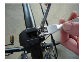
Ziehen Sie den Schnellverschluss am Lenkervorbau fest, bringen Sie den Lenker in die gewünschte Position und verriegeln Sie den Schnellverschluss.
