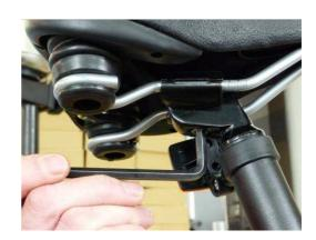
Schieben Sie nun die Sattelstütze in das Sattelrohr und verschließen Sie den Schnellverschluss. Achten Sie darauf, dass die Sattelstütze nicht wandert.
