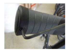
Lösen Sie die Befestigungsschraube an der Bremshebeleinheit, bringen Sie die Bremshebel in eine für Sie passende Position und ziehen Sie die Schraube wieder an. Bringen Sie die Ergogriffe in eine für Sie passende Position und ziehen Sie diese an.
