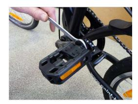
Montieren Sie nun die Pedale. Auf dem Gewindebolzen der Pedale befindet sich eine Markierung R ( für das rechte Pedal ) bzw. L ( für das linke Pedal ).
