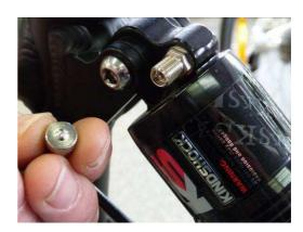
Entfernen Sie die Schutzkappe, um die Hinterradfederung einzustellen. Füllen Sie Luft nach ( Autoventil ) bzw. lassen Sie Luft ab und schrauben Sie die Schutzkappe wieder drauf.
