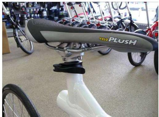
Öffnen Sie den Schnellverschluss, schieben Sie die Sattelstütze nach unten und verriegeln Sie den Schnellverschluss wieder.
