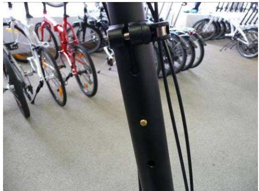
Öffnen Sie den Schnellverschluss für die Lenkerhöhenverstellung, bringen Sie den Lenker in Maximalposition und verriegeln Sie den Schnellverschluss wieder.
