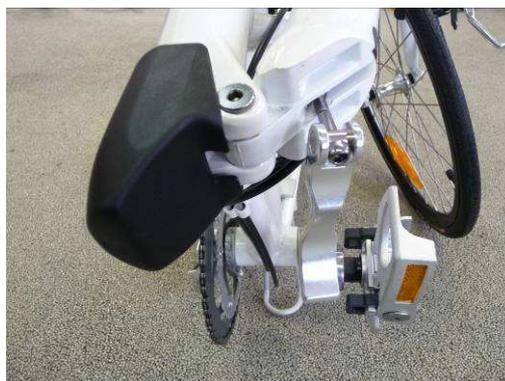
Drehen Sie die schwarze Kunststoffschutzkappe um 90° nach unten. Öffnen Sie den Hebel des Schnellverschlusses, schieben Sie diesen nach vorne und klappen Sie den Rahmen zusammen. Klappen Sie den Seitenständer ein und stecken Sie die schwarze Schutzkappe auf die hintere Rahmenhälfte.
