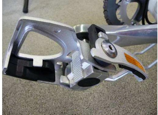
Greifen Sie in die Öffnung des Pedals und ziehen Sie die beiden Hälften nach außen.
