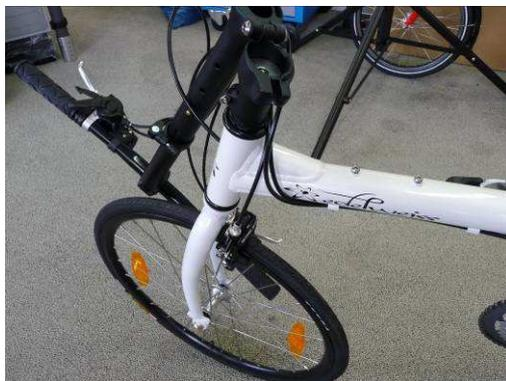
Drehen Sie das Vorderrad um 180° nach links, entriegeln Sie den Schnellverschluss am Gelenk der Lenksäule und klappen Sie diese nach unten.
